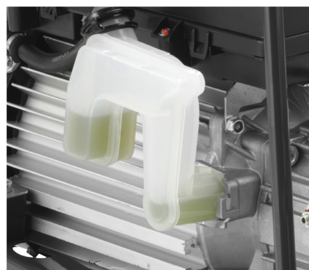
Pumpens olietank har olieskueglas og smart tøm/fyld-funktion.
