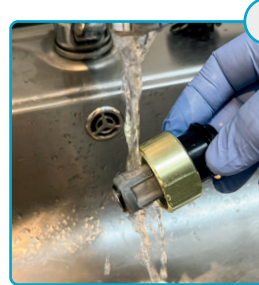
Skyl og børst filteret rent, evt. afkalk i eddike Rinse the filter, if needed, descale
