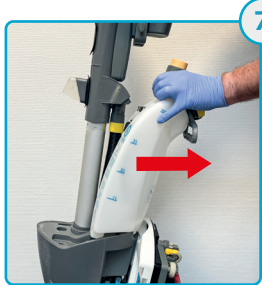
Tag rentvandstanken af Remove the clean tank
